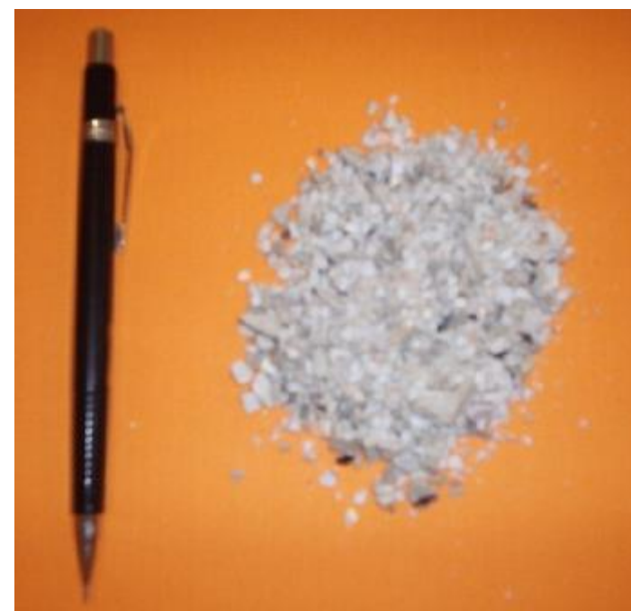
Porcelana de isolador moída para uso em concreto e argamassa.
