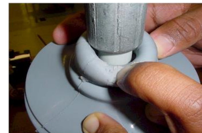
Falha de aderência
