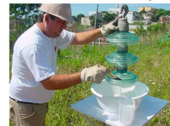
Coleta de poluentes em linha energizada
