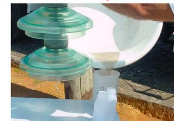
Coleta de poluentes em linha energizada
