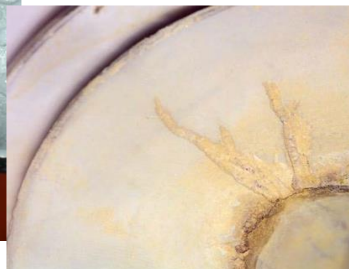
Erosão por corona na aleta
