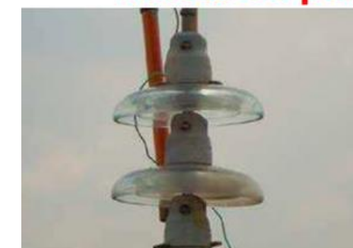
Coleta de poluentes em linha energizada
