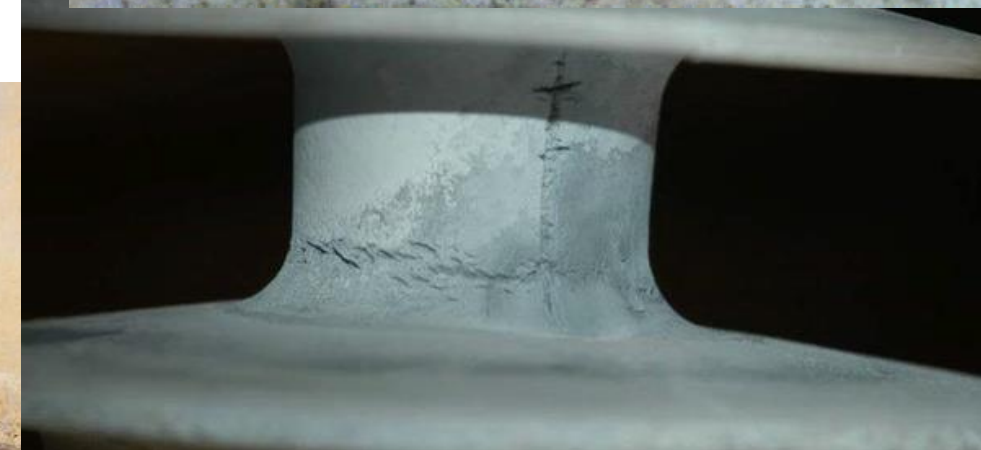
Erosão por corona no revestimento do núcleo
